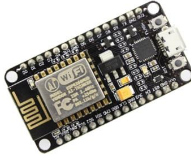
Resim 5. ESP8266 NodeMCU Cp2102 V2
