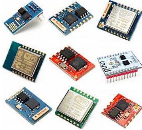
Resim 4. ESP8266 SoC'sini kullanan çeşitli modüller
